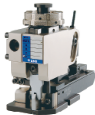
kl miniapplicatore per terminali con alimentazione lineare end feed type applicator for straight terminals
