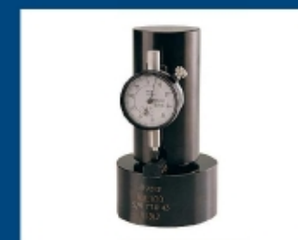
Eichungsvorrichtung um die Kontrolleeichung der Crimpmaschine. Verfügbar auch die Ausführung KM100 für die Eichweite von 135,2 mm und KM101 für die Eichweite von 135,8 mm.
