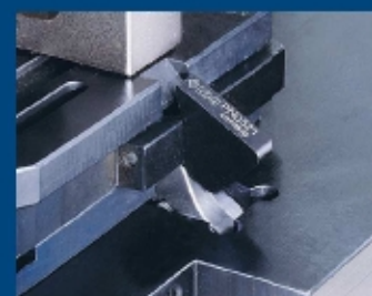
Sistema Bloccaggio Rapido Miniapplicatore Quick-charge clamping kit for miniapplicator Système de fixation rapide du miniapplicateur Schnelle Befestigung der Crimpwerkzeugen
