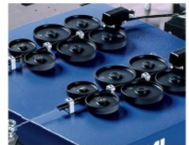
Alimentazione Doppia a Rulli Zigrinati Double Wire Feed System by Four Roller
